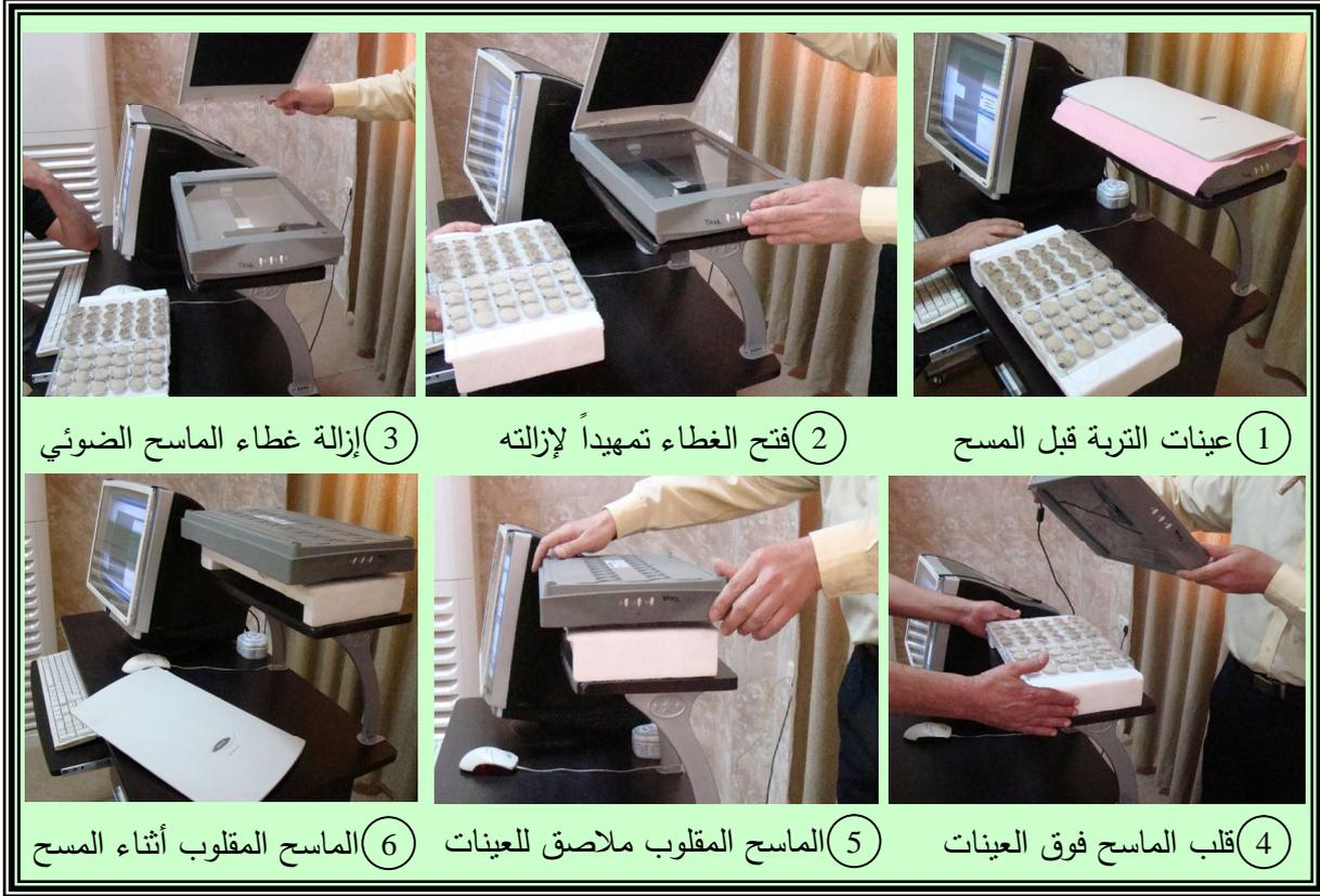
الشكل (٢) : مراحل تصوير التربة باستخدام الماسح المقلوب
