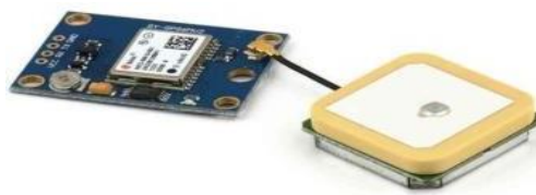
Fig. 7. Neo-6M GPS Module (Luthfi et al., 2019).
