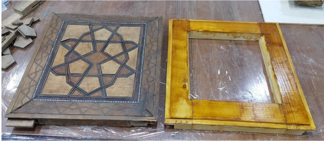
الصورة (٨) توضح عمل إطار جديد للحشوة السفلى بسبب فقدانه بالكامل
