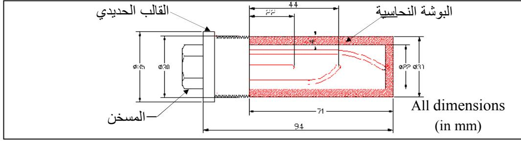
الشكل (4): رسم توضيحي لأنبوب الاختبار وبداخله المسخن.
