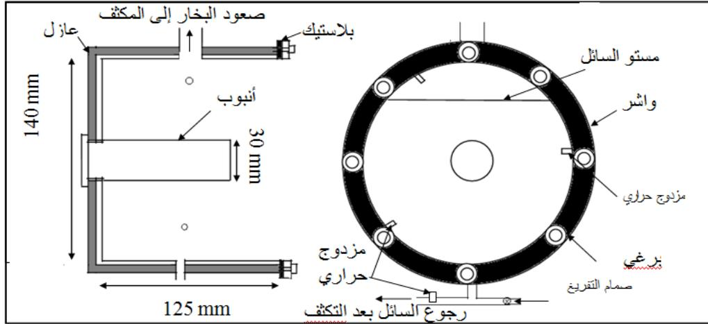
الشكل (1) : رسم توضيحي لحوض الغليان وبداخله أنبوب الاختبار ومواقع المزدوجات الحرارية فيه
