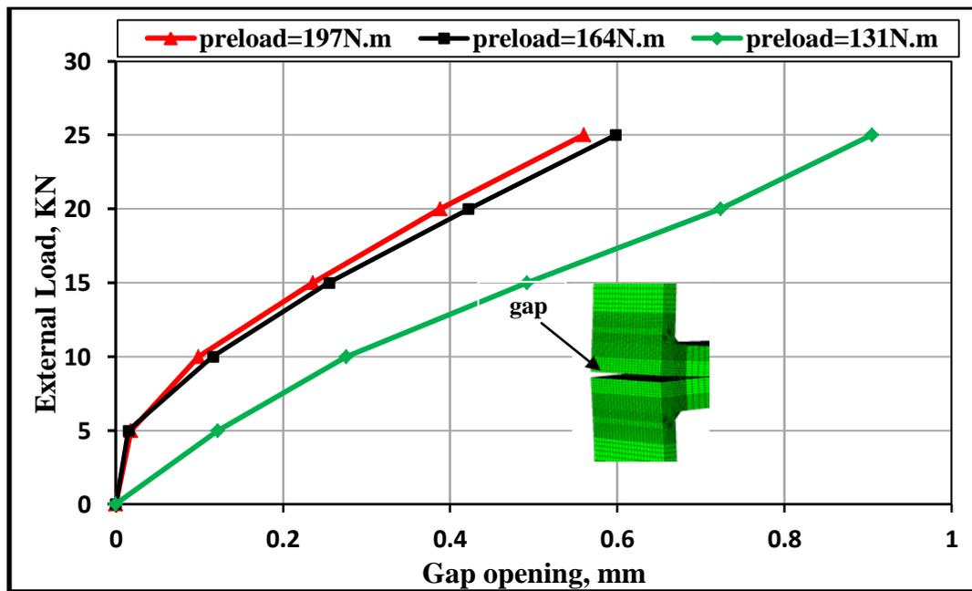
الشكل (8): الحمل الخارجي مع ازاحة حافتي وصلة الربط عند تغير عزم الشد وخطوة البرغي وباستخدام فلانة فولاذ قطر 30mm .
