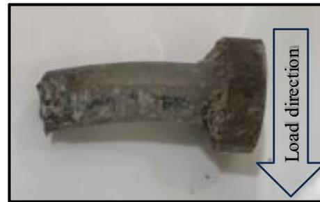
a. Shear stud failure
